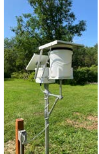
Équipement d'échantillonnage des pluies acides
