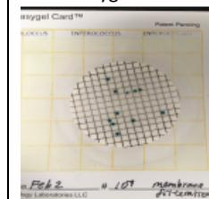
Portée de détection de la bactérie *E. coli* et de l'entérocoque : 7 à 16 CFU/100 ml
