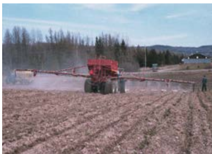
Figure 3. Fonctionnement de l'épandeur d'engrais pneumatique avec bacs collecteurs d'engrais
