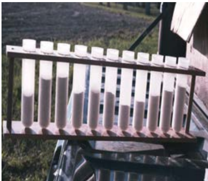
Figure 4. Schéma d'épandage démontré avec l'aide d'éprouvettes
