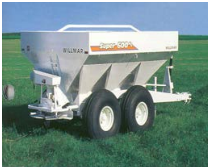
Figure 2. Épandeur à la volée (à double disque tournant)
