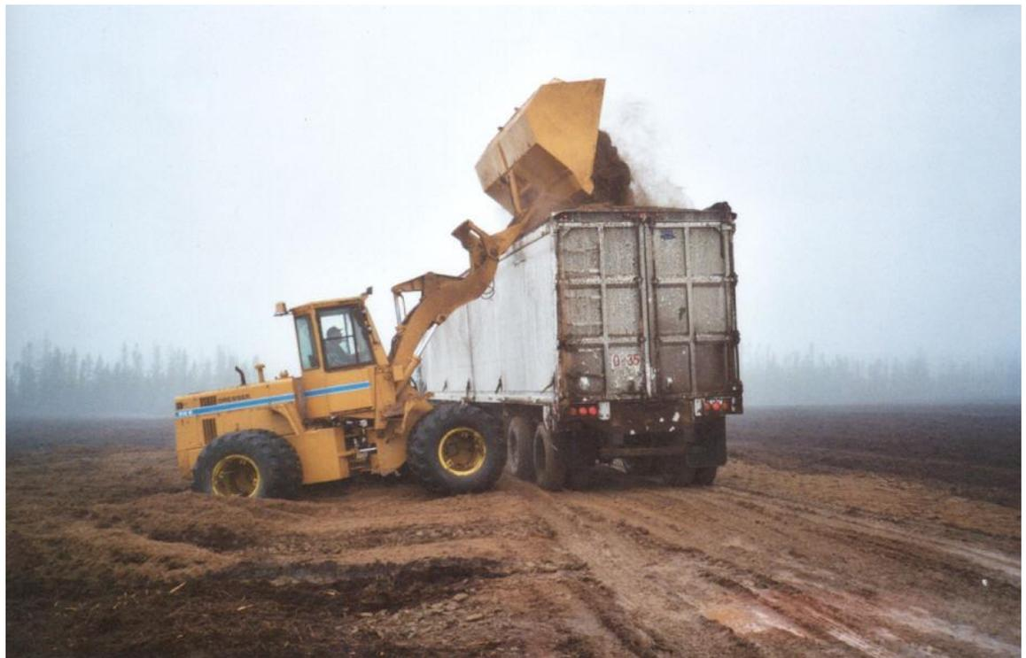
Chargement d'une remorque (wood-chip trailer) avec loader muni d'une pelle surdimensionnée.
