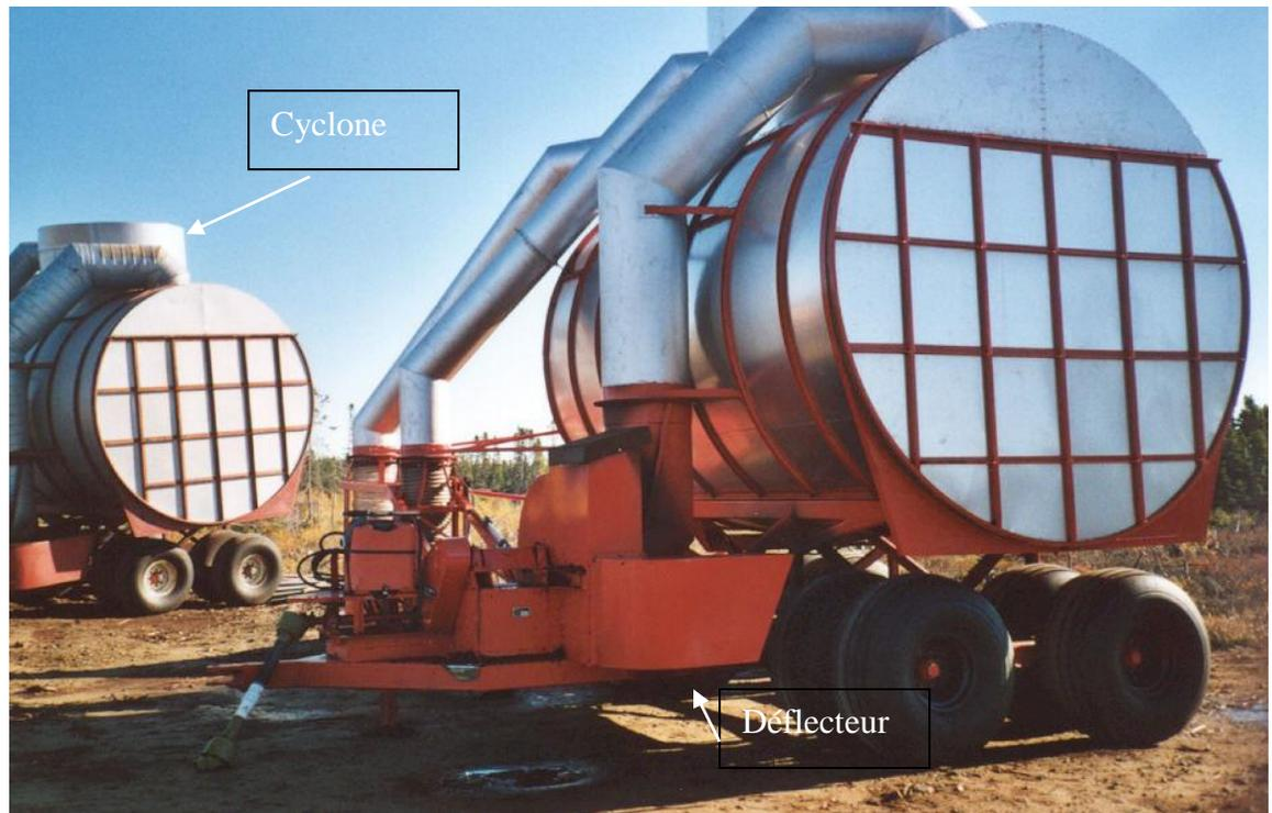
Cyclone et Déflecteur au sol de la sortie d'air
